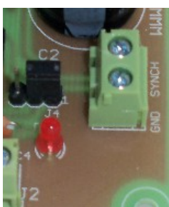
Piny złącza synchronizacji P3
